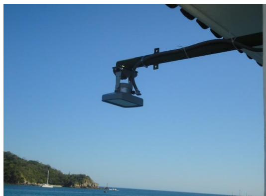
Imagen 3. Fotografía de un mareógrafo de radar RLS de OTT instalado en una de las estaciones del SMN.
