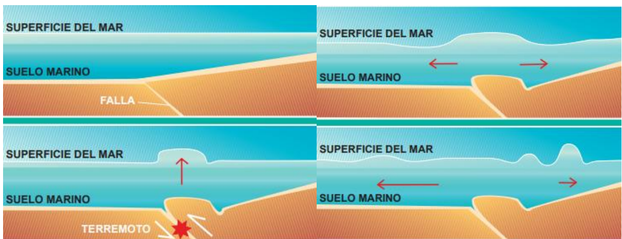
Figura 15. Proceso de formación de un tsunami generado por un deslizamiento vertical en el fondo oceánico (IOC, 2012).
