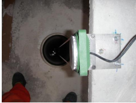
Imagen 2. Fotografía de un flotador SE 200 de OTT instalado dentro de una de las estaciones mareográficas del SMN.
